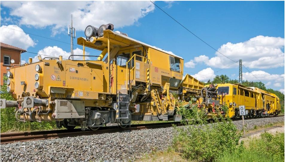
*Der Schotterpflug (links) und die Gleisstopfmaschine standen am 14.5.24 in Wicklesgreuth auf Gleis 5. Das km-Schild 0,0 bezieht sich auf den Löhe-Express.*
